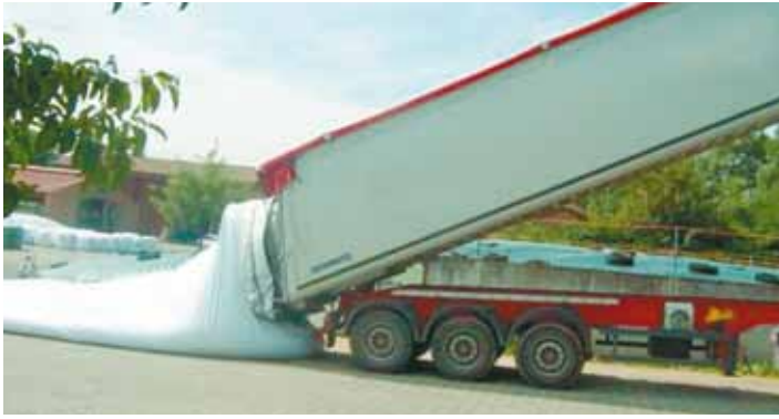
Über einen am Transportfahrzeug befindlichen Folientunnel wird der Biertreber direkt in einen Folienschlauch abgekippt.
